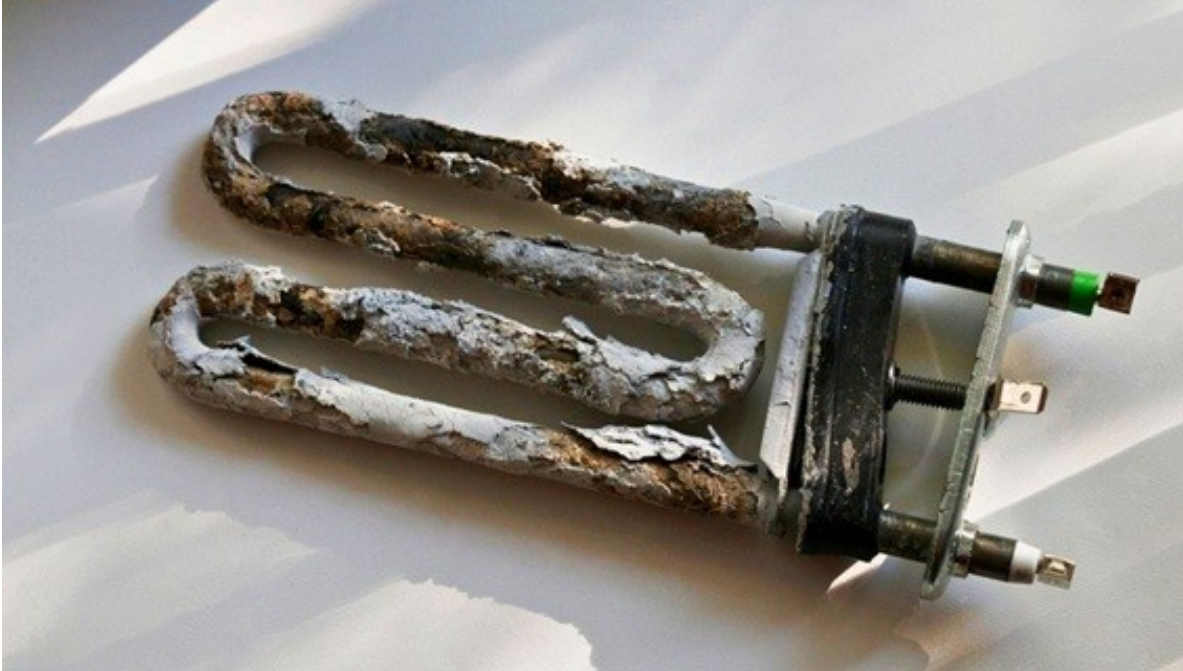
Resistencia con fuerte acumulación de sarro y corrosión superficial.
